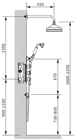
Определите точное место установки смесителя.
